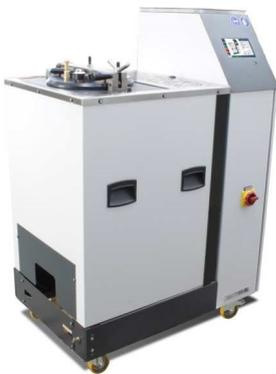
GR22 Tankschmelzgerät mit 20 Liter Volumen und FlexControl-
