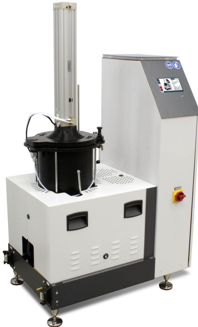
Effizientes und wartungsfreundliches Beutelpressgerät GR21 zum schonenden Verarbeiten und Dosieren von durch Feuchtigkeit vernetzenden Hotmelts; mit Reservoir für unterbrechungsfreien Betrieb während des Nachfüllvorganges sowie standardmäßig integrierter Lufttrockner-Schutzbegasung. Die komplette FlexControl-Grundausstattung umfasst Wochenzeitschaltuhr, Betriebsstunden- und Schaltspielzähler sowie das Rezeptmenü.
