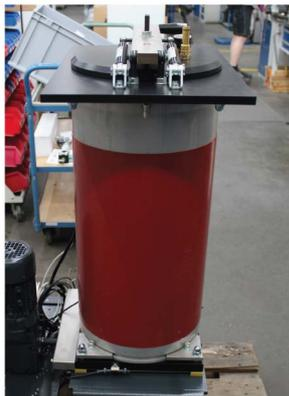
Beheiztes Tankrohr mit Drucklufttrocknung und Druckmessumformer
