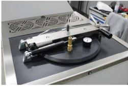
Luftdicht verschließbarer Tankdeckel
