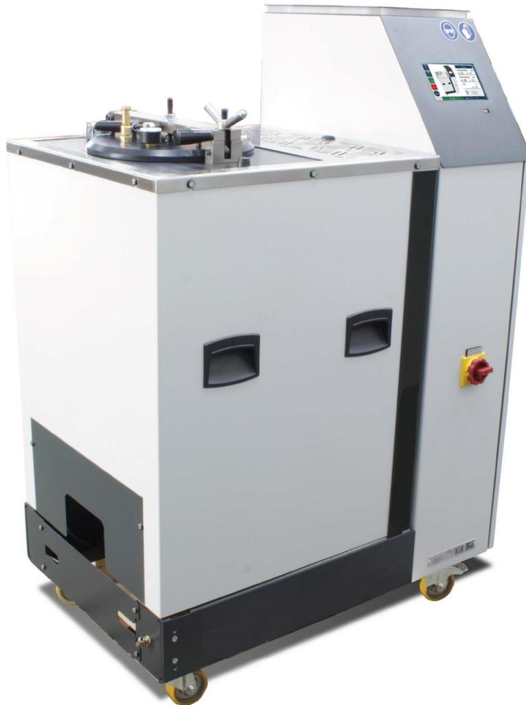
Effizientes und wartungsfreundliches Schmelzgerät GR22 zum schonenden Verarbeiten und Dosieren von durch Feuchtigkeit vernetzenden Hotmelts; mit einem Tankvolumen von 20 L für unterbrechungsfreien Betrieb während des Nachfüllvorganges sowie standardmäßig integrierter Lufttrockner-Schutzbegasung. Die komplette FlexControl-Grundausstattung umfasst Wochenzeitschaltuhr, Betriebsstunden- und Schaltspielzähler sowie das Rezeptmenü.
