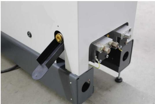
GS20 als Doppelpumpen-Variante mit Leimablass-Vorrichtung
