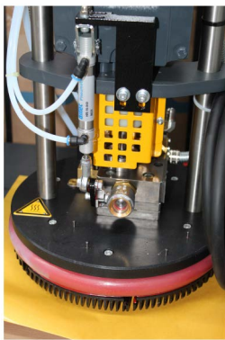
Schmelzplatte mit automatischer Entlüftung
