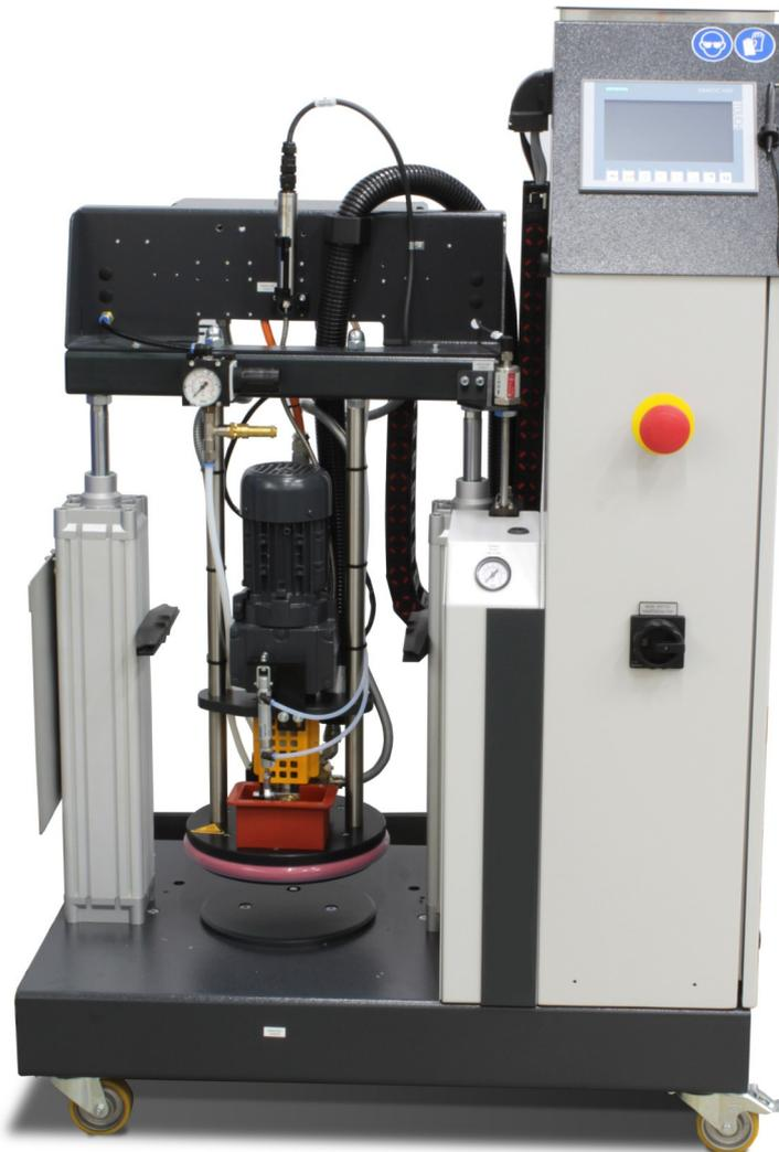
Das Maschinenkonzept bestehend aus pneumatischen Druckzylindern und beheizter antihalt-beschichteter Folgeplatte mit Zahnradpumpe in konfigurierbarer Ausführung, gewährleistet einen wartungsarmen Betrieb beim Schmelzen und Fördern von geeigneten thermoplastischen oder reaktiven Kleb- und Dichtstoffen. Eine optimale Bediensicherheit wird mittels diverser Überwachungen und Betriebszustandsanzeigen, sowie einer Zweihand-Bedienung erreicht.
