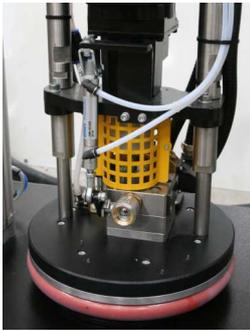
Schmelzplatte mit automatischer Entlüftung
