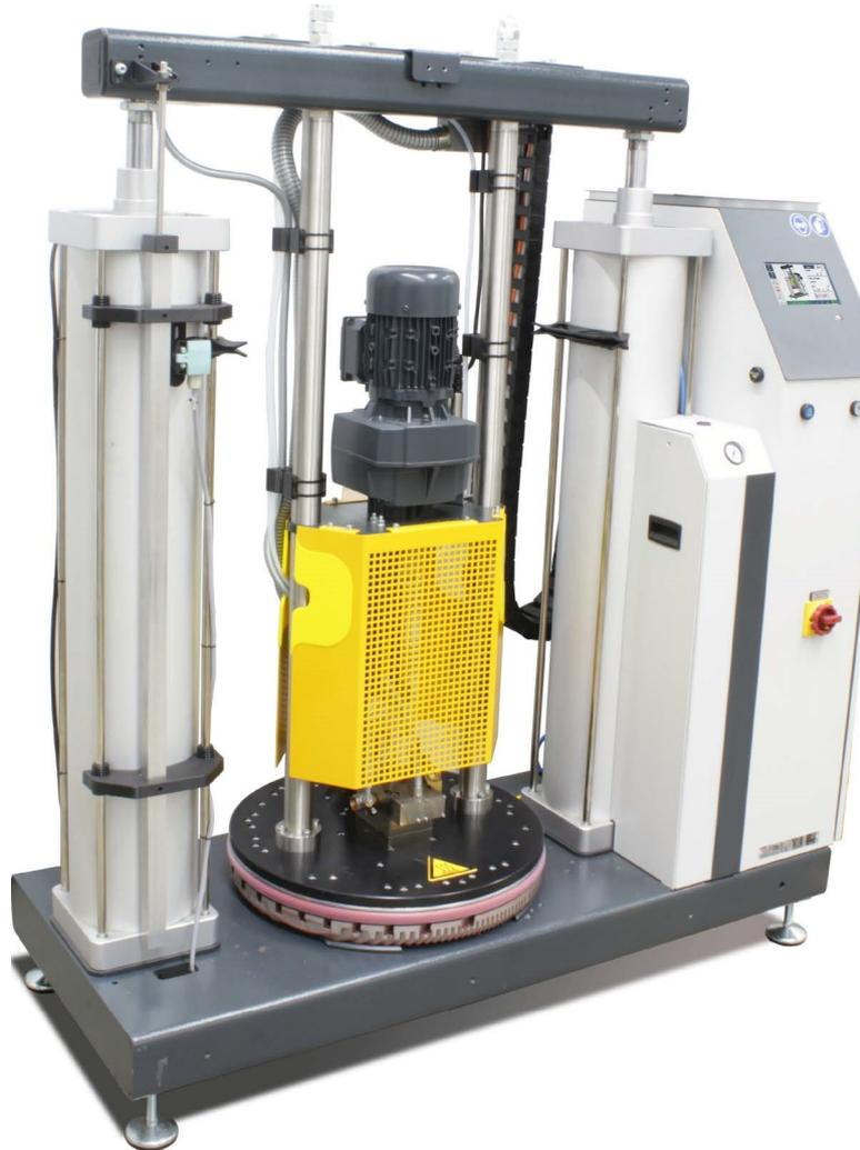
Das Maschinenkonzept besteht aus pneumatischen Druckzylindern und einer beheizten segmentierten Folgeplatte mit Zahnradpumpe in konfigurierbarer Ausführung. Dies gewährleistet einen wartungsarmen Betrieb beim Schmelzen und Fördern von geeigneten thermoplastischen oder reaktiven Kleb- und Dichtstoffen. Eine optimale Bediensicherheit wird mittels diverser Überwachungen und Betriebszustandsanzeigen, sowie einer Zweihand-Bedienung erreicht.
