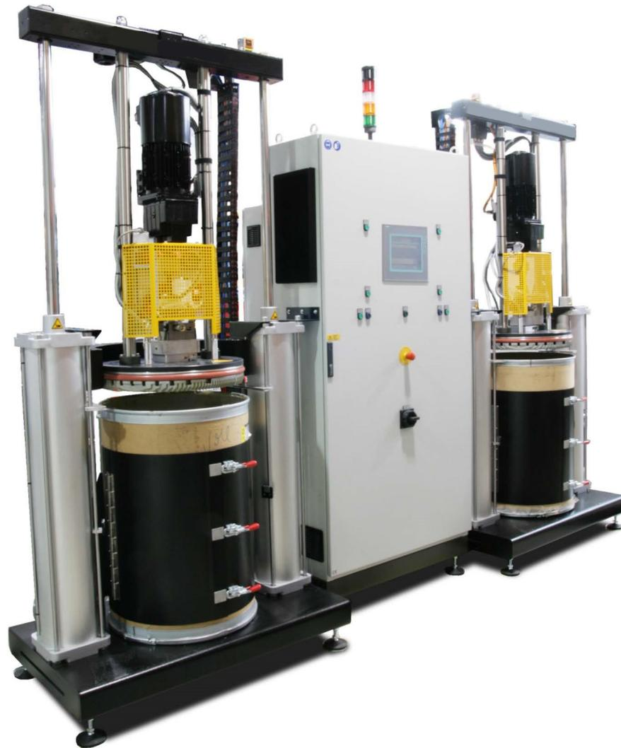
Das Maschinenkonzept bestehend aus pneumatischen Druckzylindern und beheizten segmentierten Folgeplatten mit Zahnradpumpen in konfigurierbarer Ausführung, gewährleistet einen wartungsarmen Betrieb beim Schmelzen und Fördern von geeigneten thermoplastischen oder reaktiven Kleb- und Dichtstoffen. Eine optimale Bediensicherheit wird mittels diverser Überwachungen und Betriebszustandsanzeigen, sowie einer Zweihand-Bedienung erreicht.
