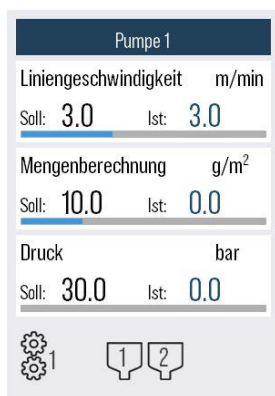
Menü „Dosiermeter“ Funktion - Automatische Drehzahlsteuerung nach Mengenvorgabe in g/m 2 oder g/lfdm
