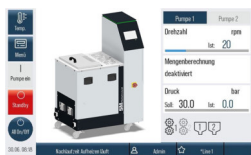
FlexControl Startbildschirm Touch-Panel Bedieneinheit
